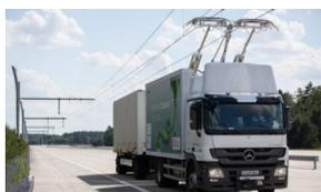
Un autre projet inattendu que l'on doit à Mercedes et Siemens, propose d'électrifier certains tronçons de routes à la manière d'une voie de tramway, et d'équiper des camions de pantographes<sup>6</sup> (cf photo). Des autoroutes expérimentent ce dispositif depuis 2016. Cette solution a l'inconvénient de compter sur le réseau électrique publique, comme n'importe quelle voiture électrique.
